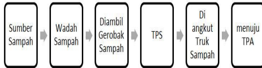
Gambar 4. Sistem Pola Individual Tak Langsung
